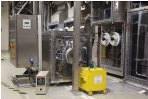
Plynný zdroj 83\text{mKr} v Tritiové laboratoři v Karlsruhe (zdroj projekt KATRIN).
