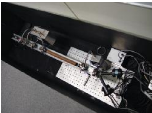
Jedno z prvních zařízení pro testy kvantové kryptografie, nalevo je vysílající Alice, napravo je přijímající Bob a mezi nimi třicet centimetrů dlouhý kvantový kanál. (Zdroj J.A. Smolin: IBM J. Res. & Dev. vol. 48 no. 1, leden 2004)
