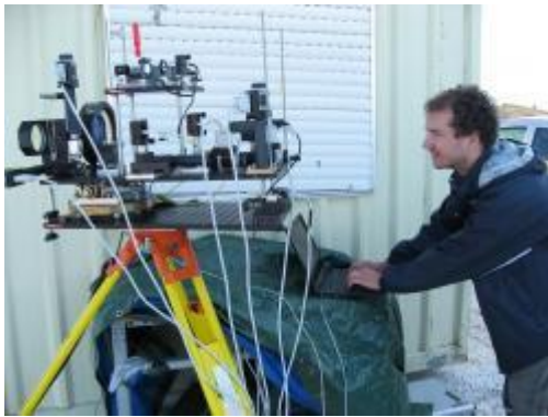
Přístroj vysílající dvojice fotonů v propleteném stavu z ostrova La Palma v experimentu rakouských fyziků. (Zdroj: článek Alessandra Fedrizziho a kol. na 2Physics)
