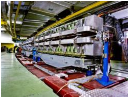
Protonový synchrotron v laboratoři CERN připravuje protony jak pro další urychlení v urychlovači SPS před vstříknutím do urychlovače LHC, tak i k produkci antiprotonů pro antiprotonový zpomalovač (zdroj CERN).
