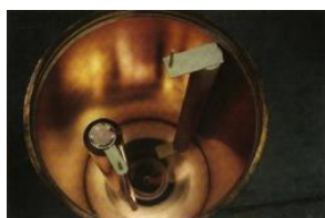
Pohled do rezonanční dutiny experimentu ADMX (zdroj ADMX).
